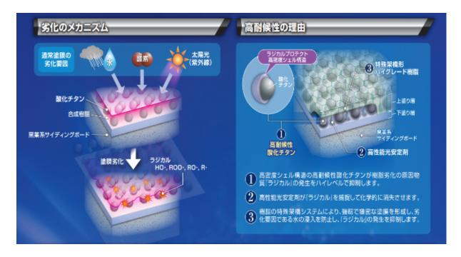
ラジカル塗料とは、塗膜の劣化原因であるラジカルの発生を抑制する
